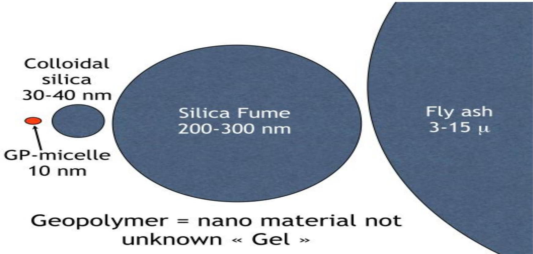
地聚物胶粒10 nm; 硅胶30-40 nm; 硅灰200-300 nm;
